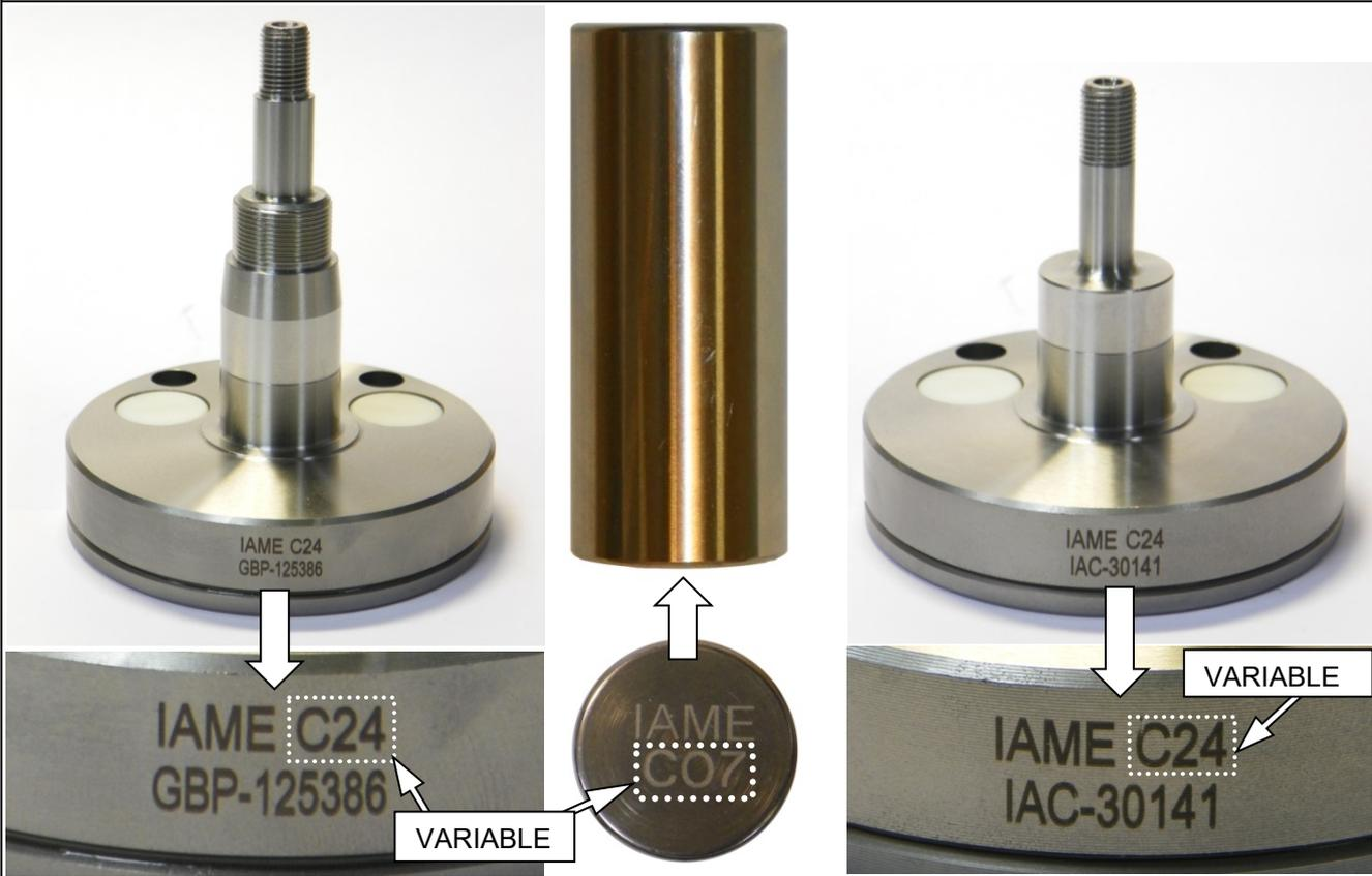
SPROCKET IDENTIFICATION MARKING
