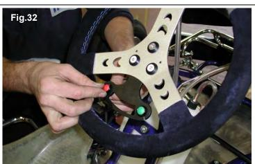
**3.8.10** CONNECT THE BUTTON CONNECTORS WITH THE HARNESS CONNECTORS (SEE FIG.33).
