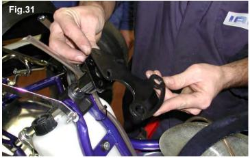
**3.8.9** ASSEMBLE THE PUSH BUTTONS INTO THE SUPPORT BRACKET (SEE FIG.32).
