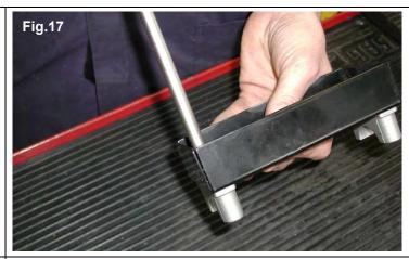
**3.7.1** POSITION THE SUPPORT ON THE CHASSIS REAR RAIL (SEE FIG.18).
