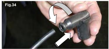
**3.8.12** FIX THE SPARK-PLUG CAP ON THE H.T. CABLE WITH A PLASTIC CLAMP (SEE FIG. 35).
