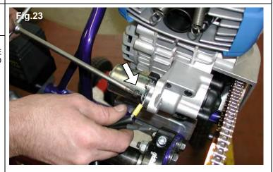
**3.8.1** CONNECT THE TERMINAL (8mm) OF THE HARNESS TO THE STARTER (SEE FIG.24).
